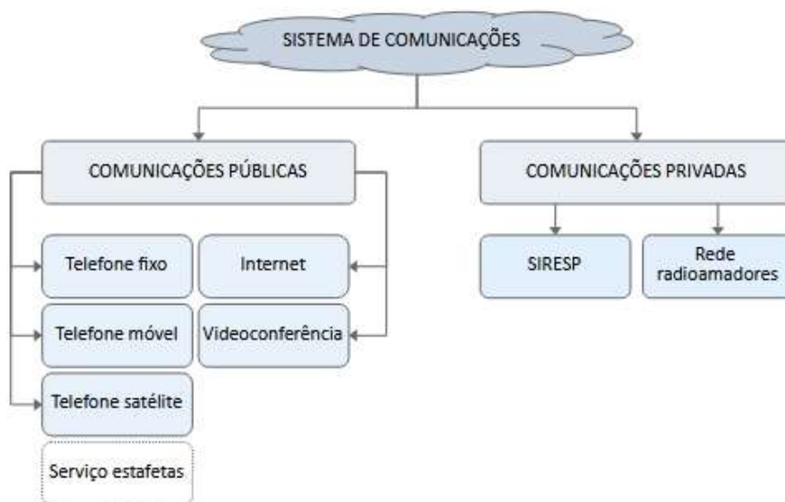
Figura 15 – Redes e Serviços de Comunicações de Emergência
